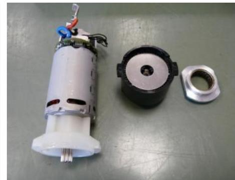
1. 从电机机箱中取出电机齿轮传动装置
