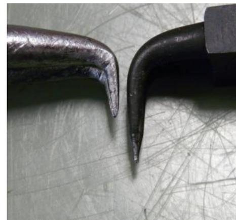
将卡环从铝质法兰中取出前，必须将弹簧连同定位环一起夹紧到止挡位置。这样，才有足够的空间使卡簧钳接触到卡环。此时，必须使用常规卡簧钳。（右图）
