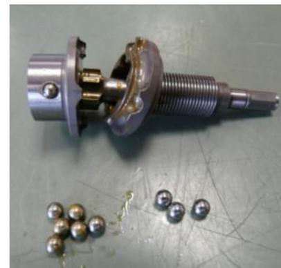
1. 从工具支架上取下定位环、止推环和压紧弹簧
