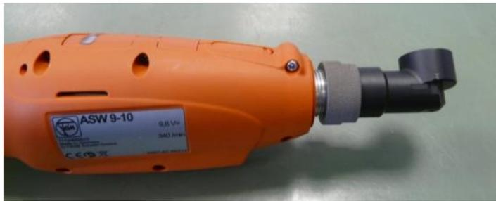
Cabezal de engranaje desatornillado hasta el tope
