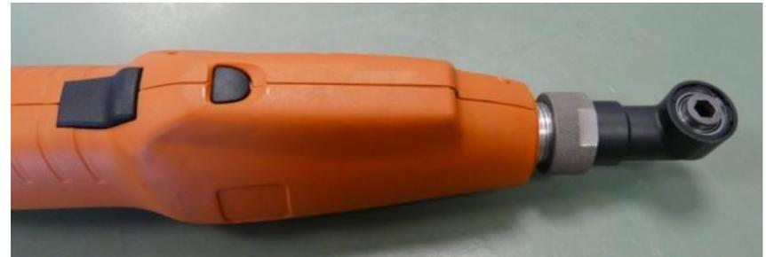
Cabezal de engranaje colocado en la posición de trabajo correcta girándolo hacia atrás – Estado de suministro portaherramientas siempre en una línea con los pulsadores de conmutación
