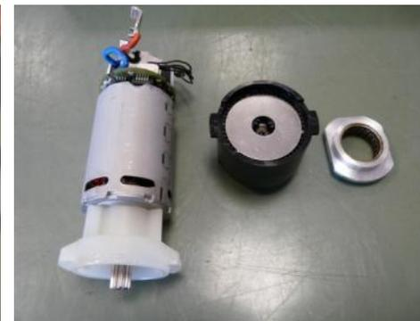
1. Motor – Sacar la unidad de engranaje de la caja del motor
