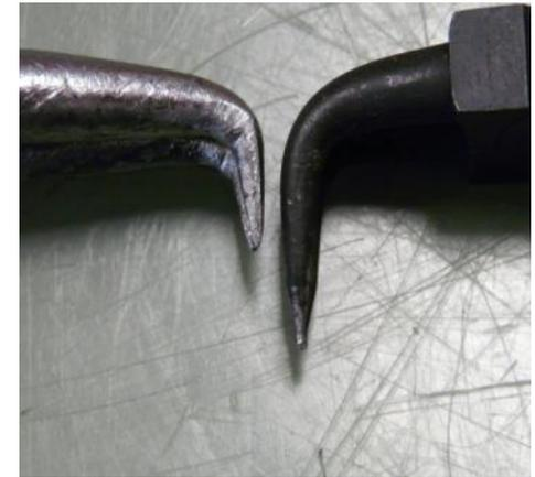
Para poder retirar el anillo de retención de la brida de aluminio es preciso tensar primero el resorte con el anillo de ajuste hasta el tope. Esto es necesario para crear suficiente espacio intermedio y llegar con unas pinzas de anillo de retención Seeger hasta el anillo de retención. Sin embargo, para este caso deberán amolarse unas pinzas de anillo de retención Seeger usuales en el comercio. (imagen derecha)
