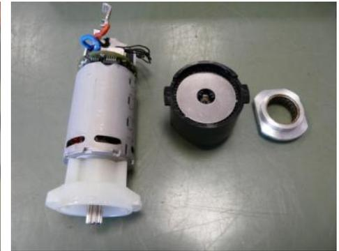
1. Retirer l'unité d'engrenage moteur du boîtier moteur
