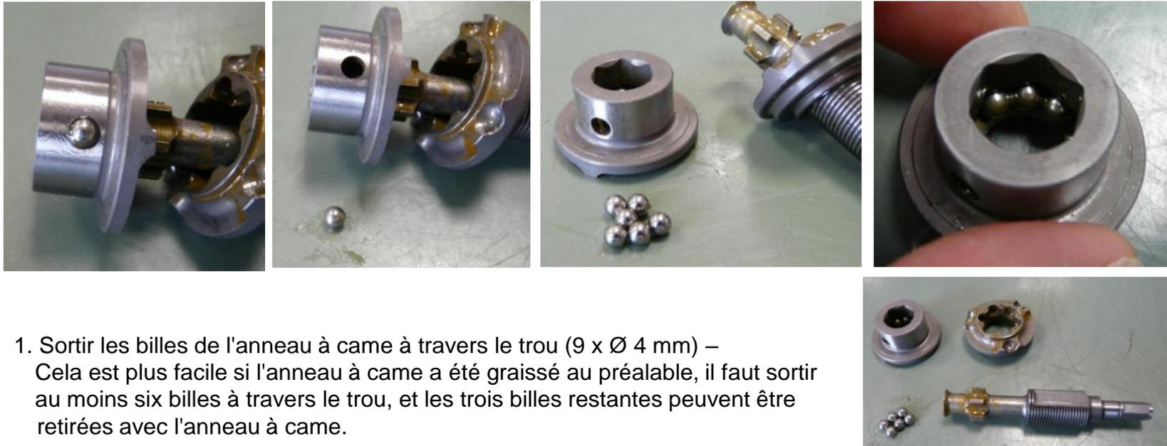
1. Sortir les billes de l'anneau à came à travers le trou (9 x Ø 4 mm) – Cela est plus facile si l'anneau à came a été graissé au préalable, il faut sortir au moins six billes à travers le trou, et les trois billes restantes peuvent être retirées avec l'anneau à came.
