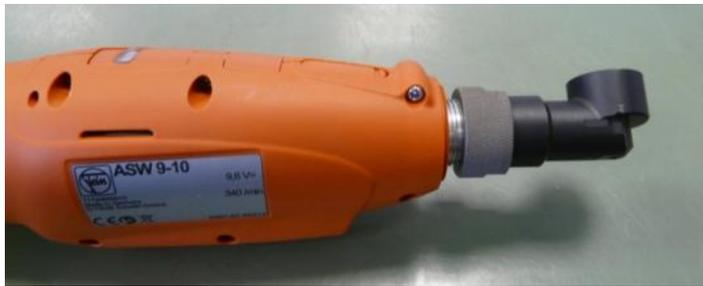
Carter d'engrenage serré jusqu'à la butée
