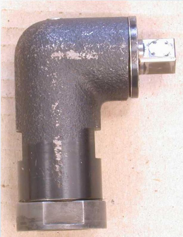
Sollten an den Getriebegehäusen, wie hier, Montagespuren zu sehen sein, sind sämtliche Garantieansprüche aufgehoben.
