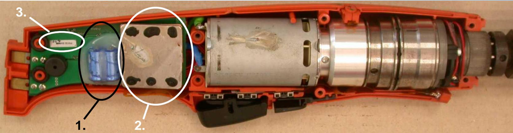
1. Kondensator C2 neben Kühlkörper mit Heißkleber verkleben
