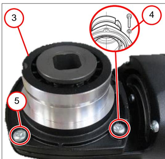
3. Установите опорную пластину (3).
