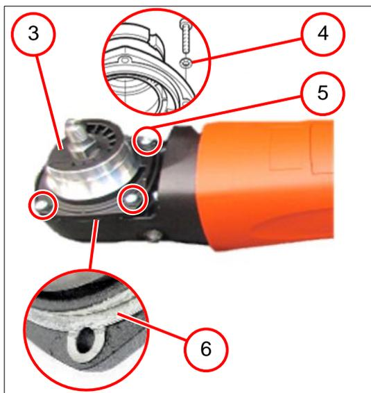
3. Установите опорную пластину (3).
