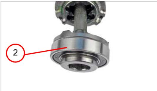
15. Das Rillenkugellager (2) entfernen.
