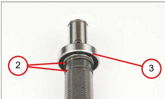
14. Die zwei Sicherungsringe (2) platzieren.
