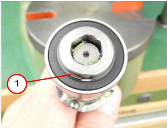
14. Den Sicherungsring (1) entfernen.
