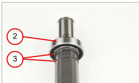
7. Das Rillenkugellager (2) entfernen.
