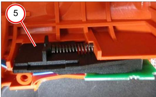
4. Schaltschieber mit Spiralfeder (5) platzieren.
