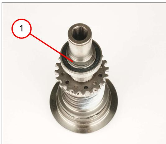
6. Den Sicherungsring (1) entfernen.
