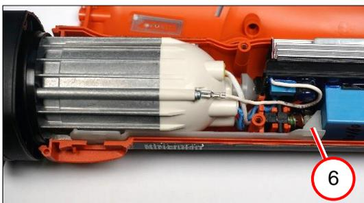
8. Die Schaltstange (6) entfernen.
