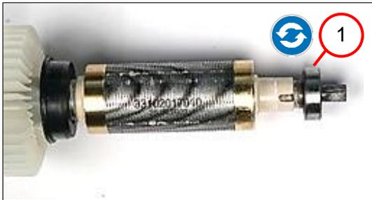
1. Das Rillenkugellager (1) abziehen.
