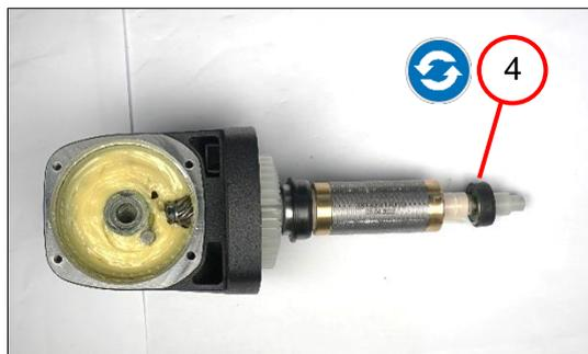
3. Die Gummibuchse (4) entfernen.
