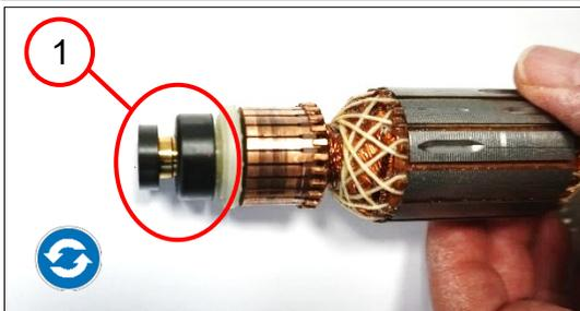
1. Das Rillenkugellager (1) mit Magnet und Abdeckung abziehen.
