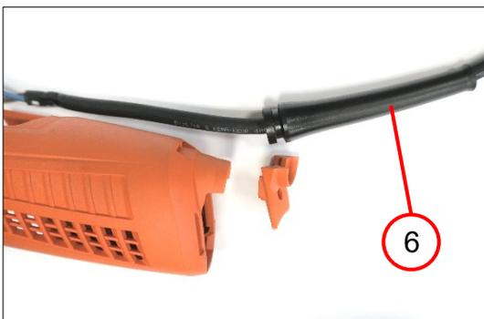
6. Die Kabeltülle (6) entfernen.
