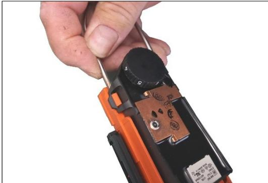
2. Die Elektronik entfernen mit Hilfsmittel
