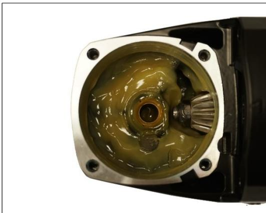
2. Das Getriebegehäuse mit 9-11 g. Fett befüllen.
