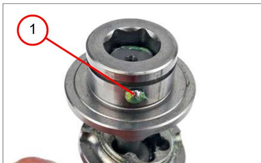
4. Enduire de graisse les neuf billes [d=4 mm] (1).
