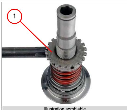
13. Placer la bague de réglage (1) [filetage à gauche].
