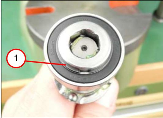
9. Placer le circlips (1).
