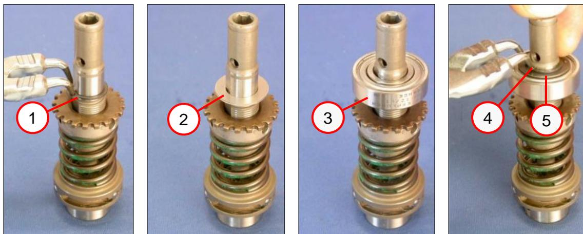
1. Установите стопорное кольцо (1) на инструментальный держатель.
