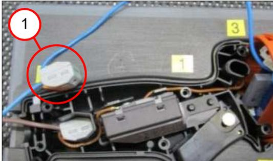
1. Die Kabel (1) anschließen.
