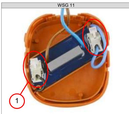
4. Die zwei Klemmen (1) öffnen und die Kabel anschließen.
