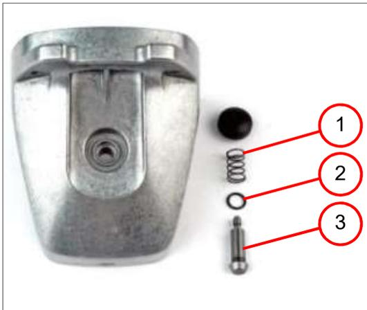
3. Die Spiralfeder (1) entfernen.
