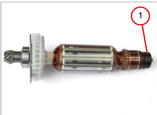
1. Die Lagerbuchse (1) entfernen.
