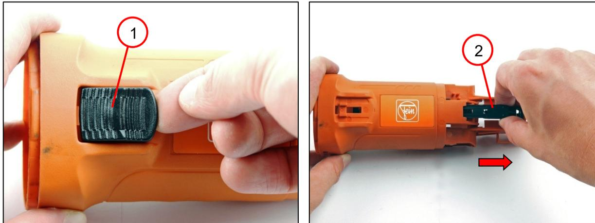
1. Den Schaltchieber (1) von der Schaltstange entfernen.
