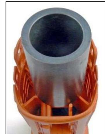
1. Den Stator (1) lagerichtig in das Gehäuse schieben.
