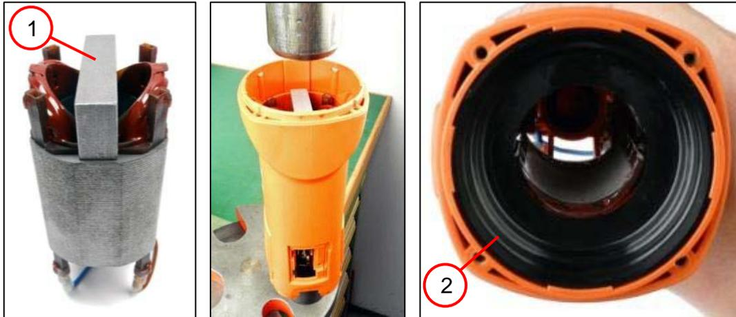
1. Das Druckstück (1) einsetzen und den Stator einpressen.
