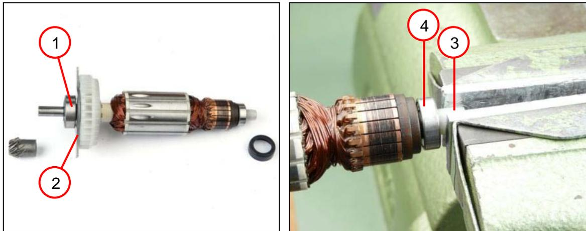
1. Das Rillenkugellager (1) entfernen.
