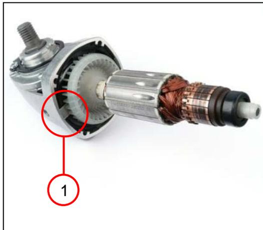
1. Den Anker in das Getriebegehäuse einpressen.
