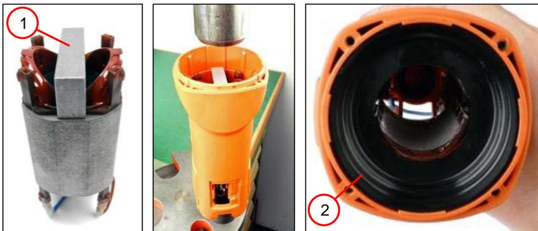
1. Instalar la pieza de presión (1) e insertar por presión el estátor.
