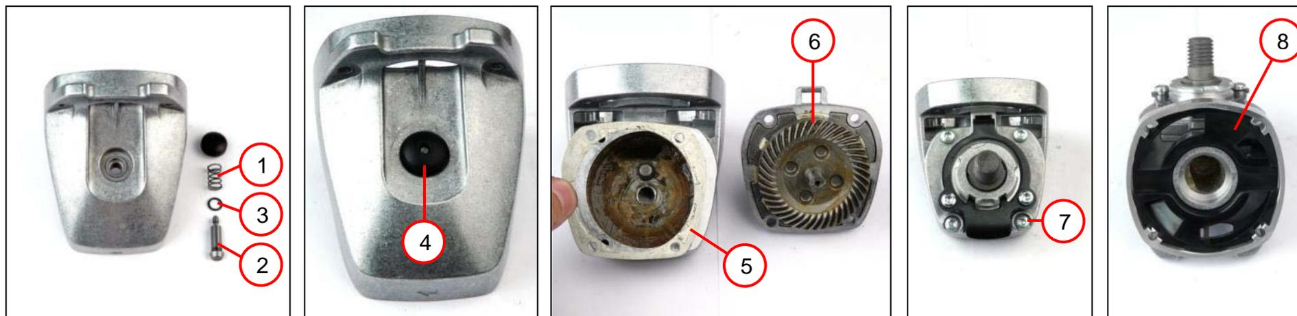
1. Instalar el resorte helicoidal (1) y el perno (2) con junta toroidal (3).
