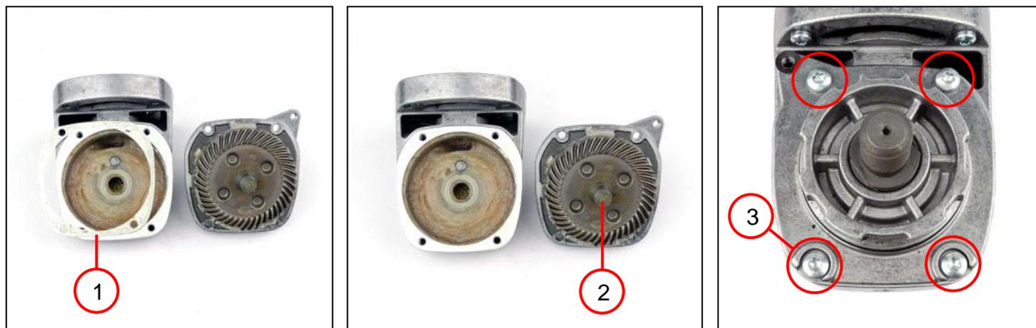
1. Компенсационная(ые) шайба(ы) (1) с обеих сторон обработайте смазкой Loctite 573 и установите их на корпусе редуктора.
