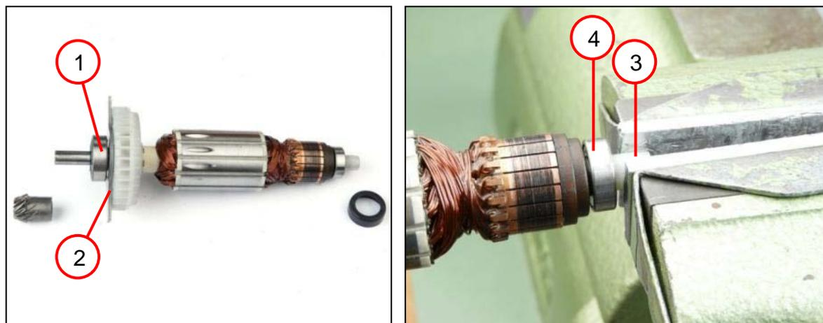
1. Снимите радиальный шарикоподшипник (1).
