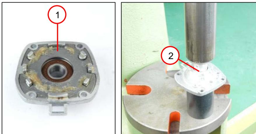
1. Снимите пластину (1).
