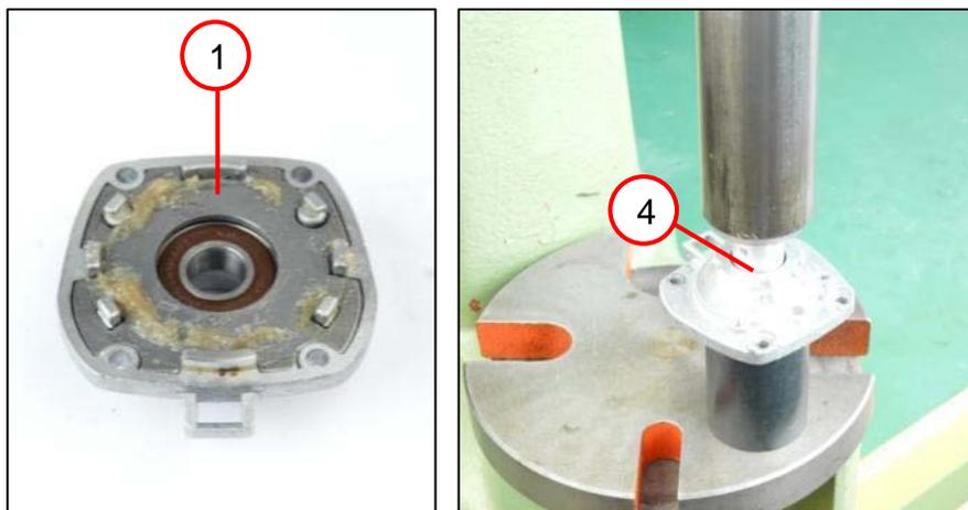
1. Снимите пластину (1).
