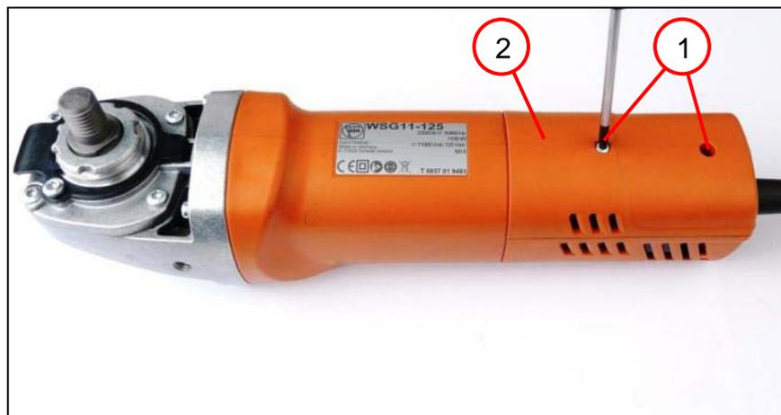
1. Вывинтите два винта (1) и снимите нижнюю часть крышки (2).
