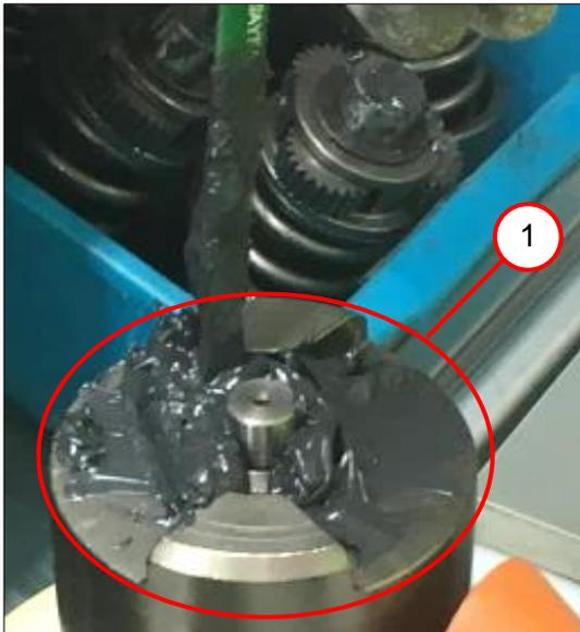
1. 用 6 g 润滑脂填充凹槽、间隙和钳口 (1)。
