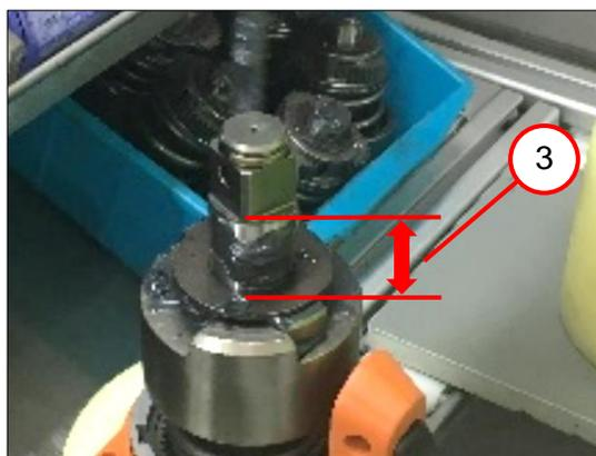
5. Смажьте вал на участке (3) 2 г пластичной смазки.
