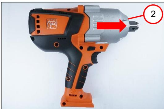
3. Потяните корпус редуктора (2) вперед примерно на 3 – 4 мм.
