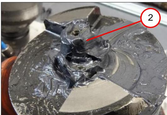
2. Смажьте цапфу вала (2) 2 г пластичной смазки.
