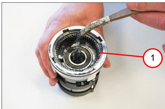
7. Смажьте зубчатое зацепление полового колеса (1) 2 г пластичной смазки.
