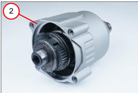
2. Снимите корпус редуктора (2).
