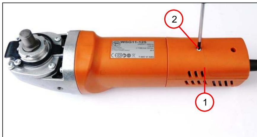
1. Placer la partie inférieure du boîtier (1) sur la partie supérieure.
