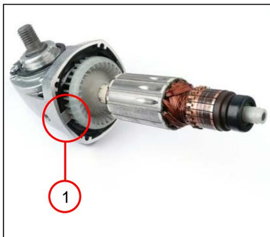
1. Presser le rotor dans le carter d'engrenage.
