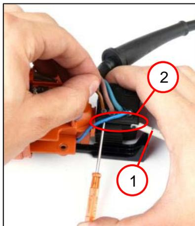
1. Ouvrir le recouvrement en caoutchouc (1).
