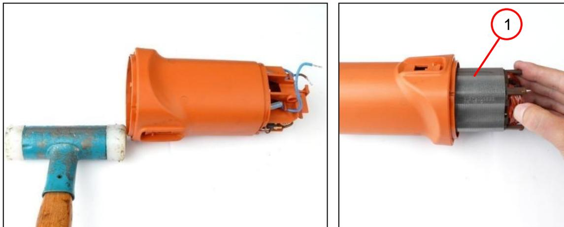
1. Den Stator (1) entfernen.
