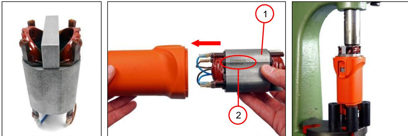
1. Den Stator (1) in das Motorgehäuse lagerichtig einpressen.
