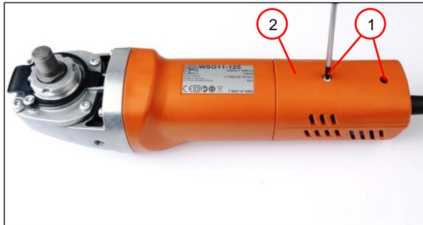
1. Die zwei Schrauben (1) herausdrehen und das Deckel-Unterteil (2) abnehmen.
