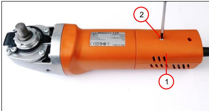
1. Das Deckel-Unterteil (1) auf das Deckel-Oberteil setzen.
