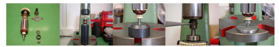
1. Anker in Aufpressvorrichtung einsetzen.
