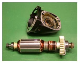
1. Anker mit Getriebegehäuse in Schraubstock einspannen Getriebegehäuse durch leichte Schläge mit Kunststoffhammer abziehen
