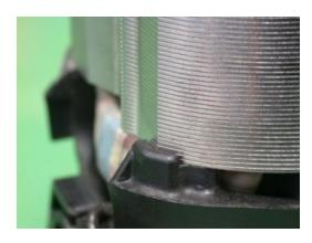
Bei korrekter Justierung der Polpaketeinheit ist zwischen Anschlag und Blechpaket kein Luftspalt vorhanden. Das Blechpaket muß am Kunststoff anliegen und fest verschraubt sein.
