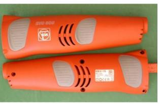
WSB 10-115 T: Motorgehäuse ca. 245mm lang
