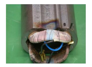
Das linke Bild zeigt einen am Polpaket streifenden Anker. (kein Lagerschaden)
