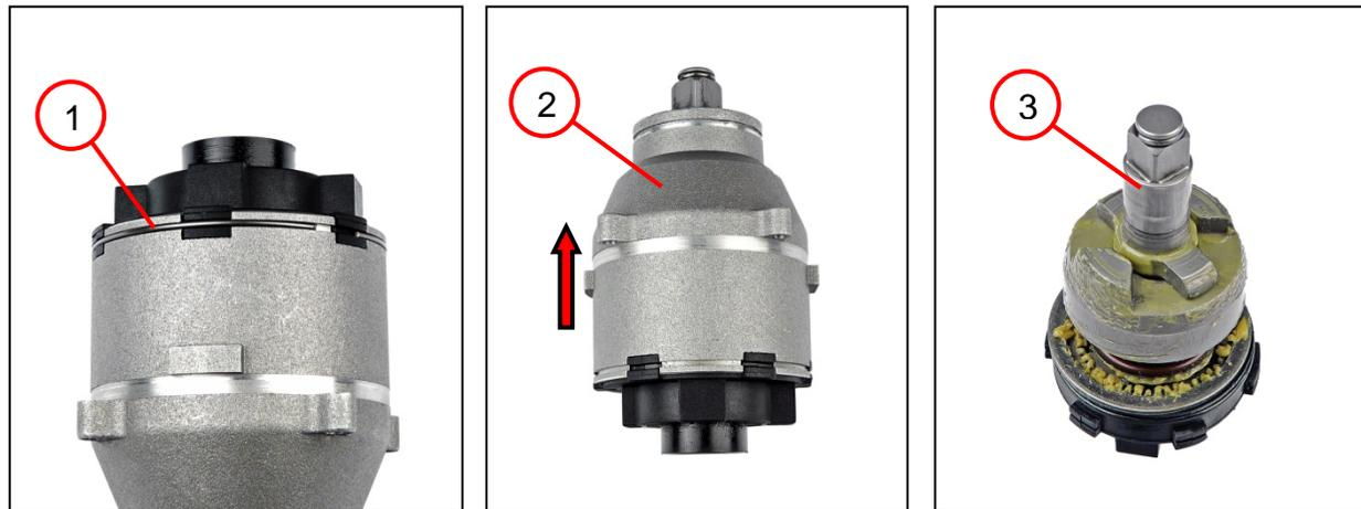
1. Den Sicherungsring (1) entfernen.
