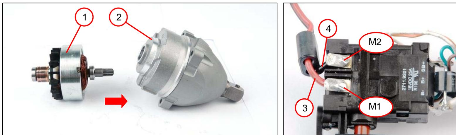
1. Pousser le rotor (1) dans l'engrenage (2).
