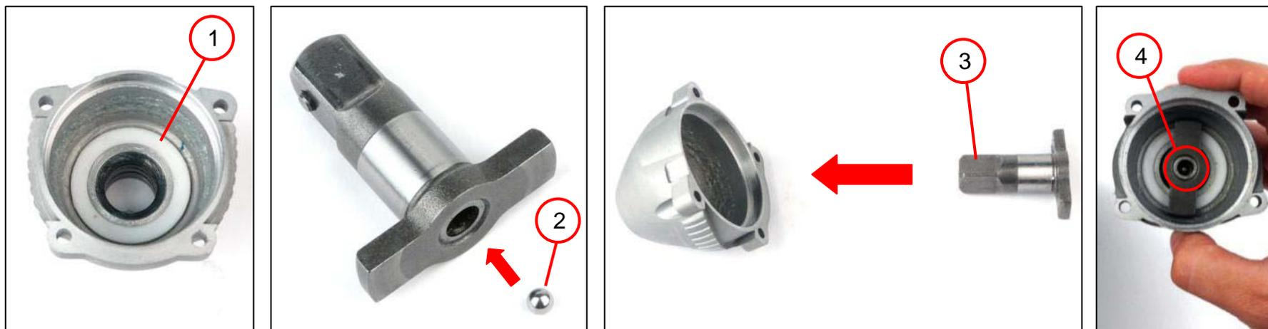
1. Insérer le disque (1) dans le carter d'engrenage.
