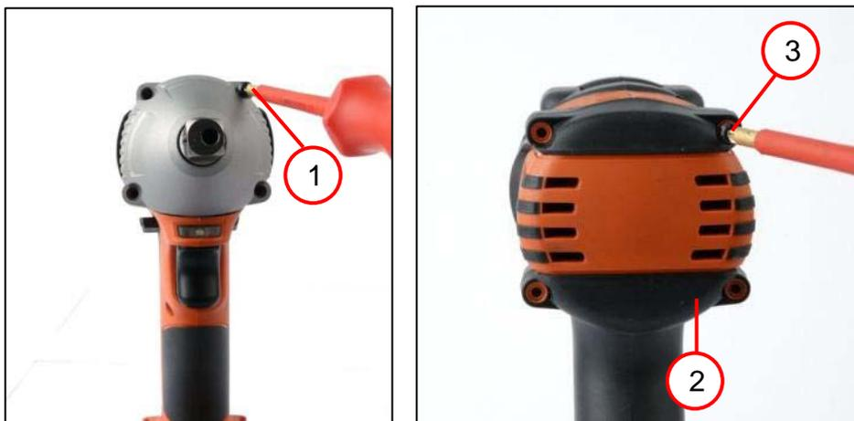
1. Visser solidement le carter d'engrenage avec les quatre vis (1) [1,3 Nm  $\pm$  0,4 Nm].
