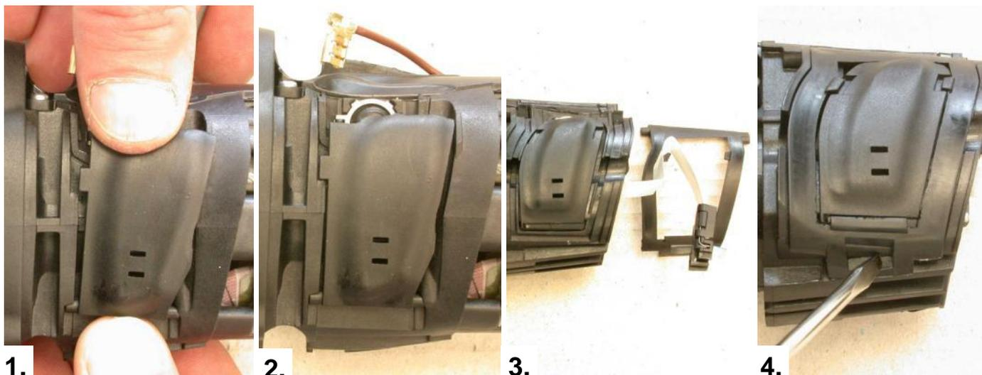
1. Installer la plaque de pression (95) (côté engrenage) en biais dans l'unité de pôles d'inducteur (10) et appuyer sur le dispositif de blocage.
