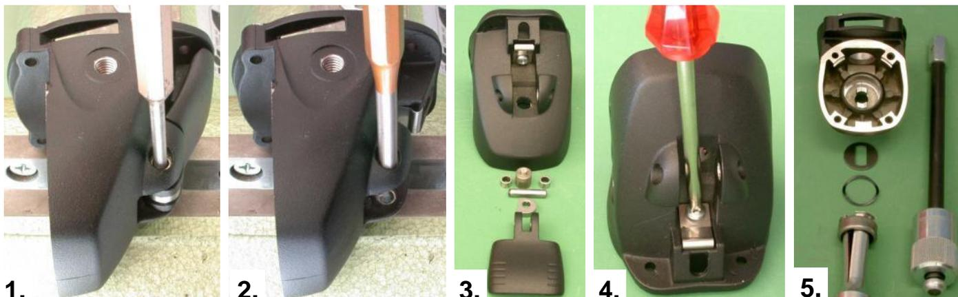
1. Visser des boulons de chasse (OS) dans les alésages filetés pour la poignée (830). Serrer solidement les boulons filetés (OS) dans l'étau. Faire sortir le boulon (500) à l'aide d'un chasse-goupilles. Retirer le levier (480), les boulons de pression (430) et l'anneau excentrique (490).
