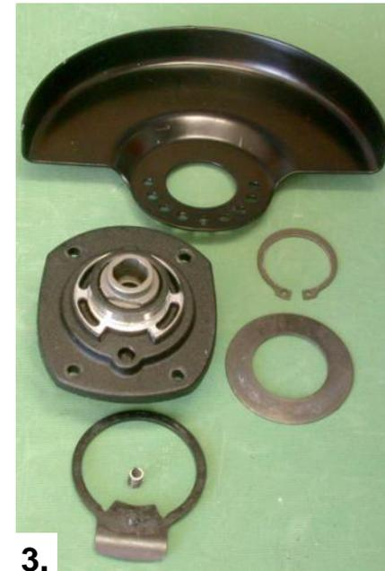
1. Flansch (670) mit zwei Schraubendrehern abhebeln.
