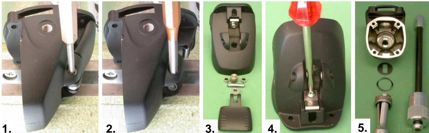
1. **Austreibbolzen (SWZ) in Gewindebohrungen für Handgriff (830) festschrauben. Gewindebolzen (SWZ) fest in den Schraubstock spannen. Bolzen (500) mit Splinttreiben herausschrauben. Hebel (480), Druckbolzen (430) und Exzenterring (490) herausnehmen.**
