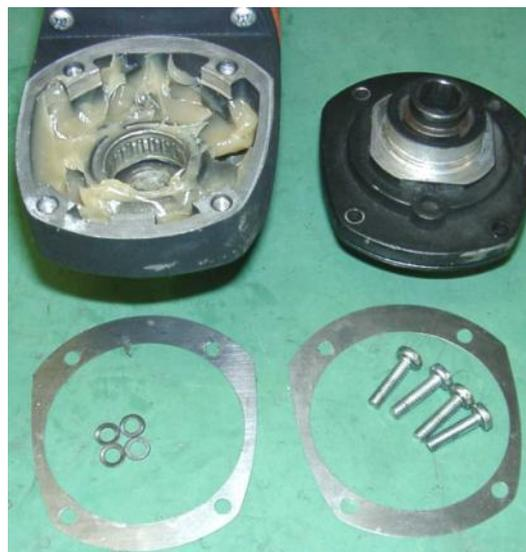
1. Presser l'arbre d'entraînement assemblé provisoirement sur le plateau de palier **(250)** .
