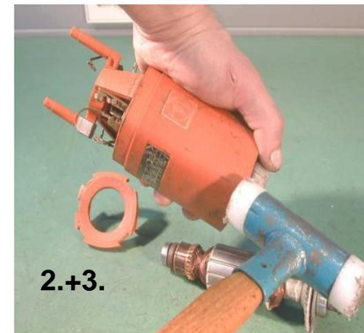
1. Détacher l'induit [\(100\)](#) de la chaise de palier en frappant légèrement sur le carter moteur [\(90\)](#) ou sur le carter d'engrenage [\(430\)](#).
