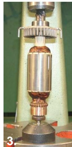
1. Introduire l'induit (100) dans le dispositif de pression par la face collecteur, placer la plaque d'extrémité (120) et presser le roulement à billes (450) avec l'appui de billes (D=26).
