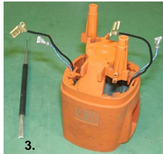
1. Presser à l'intérieur les 4 fils du bloc de pôles et introduire le bloc de pôles [\(490\)](#) dans le carter moteur [\(90\)](#).
