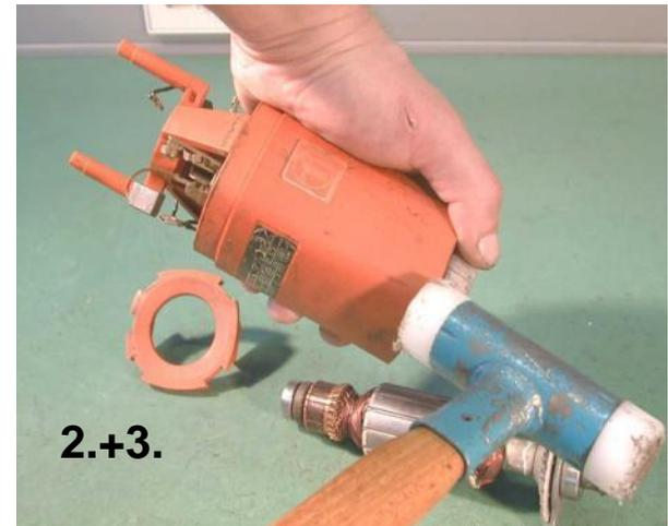
1. Mit leichten schlägen gegen das Motorgehäuse (90), bzw. gegen das Getriebegehäuse (430) ,den Anker (100) aus dem Lagersitz lösen.
