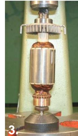
1. Anker **(100)** kollektorseitig in die Aufpressvorrichtung einführen, Abschlussplatte **(120)** auflegen und Kugellager **(450)** mit Hilfe von Kugellagerauflage (D=26) aufpressen.
