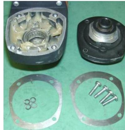
1. Vormontierte Antriebswelle in Lagerplatte **(250)** einpressen.
