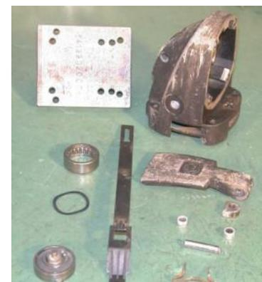
1. **Getriebegehäuse (430) in Montagevorrichtung festschrauben und in Schraubstock einspannen.**
