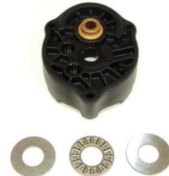
1. Retirer le disque axial et les deux disques du palier intermédiaire.
