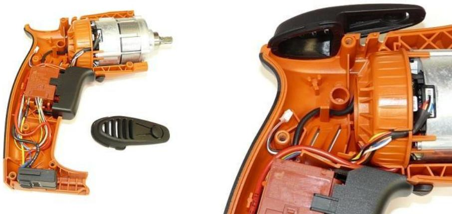
1. Insérer le crochet de ceinture dans la partie inférieure du carter.
