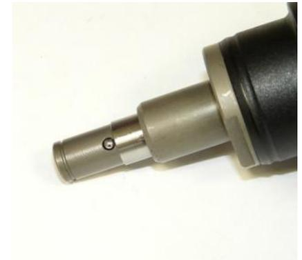
1. Desserrer le circlips et l'enlever avec le disque.
