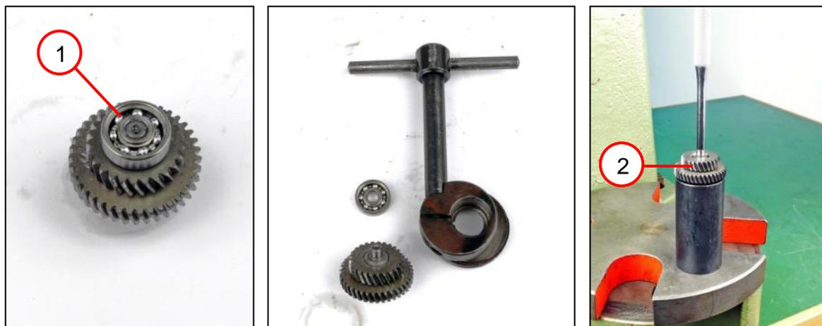
1. Снимите радиальный шарикоподшипник (1).
