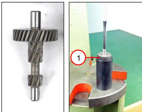
1. Выпрессуйте зубчатое колесо [Z=30] (1) с вала [Z=8].
