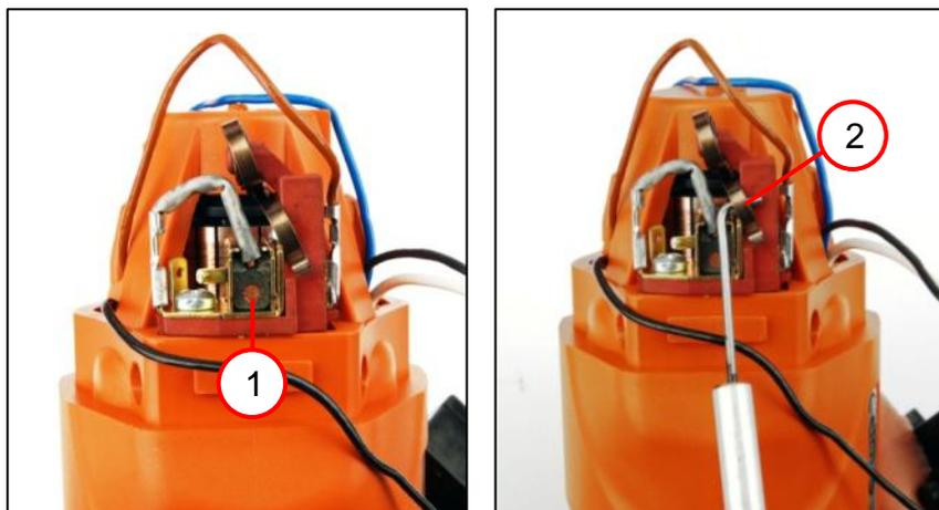
1. Insérer le balai (1) et le raccorder [des deux côtés].
