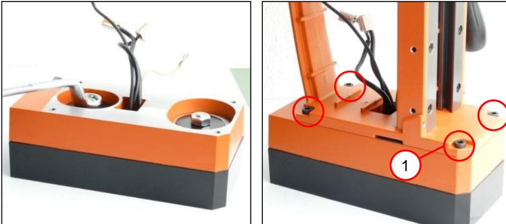
1. Das Zwischenlager mit Scheiben und Sechskantmuttern an den Magnetfuß montieren [15 Nm].
