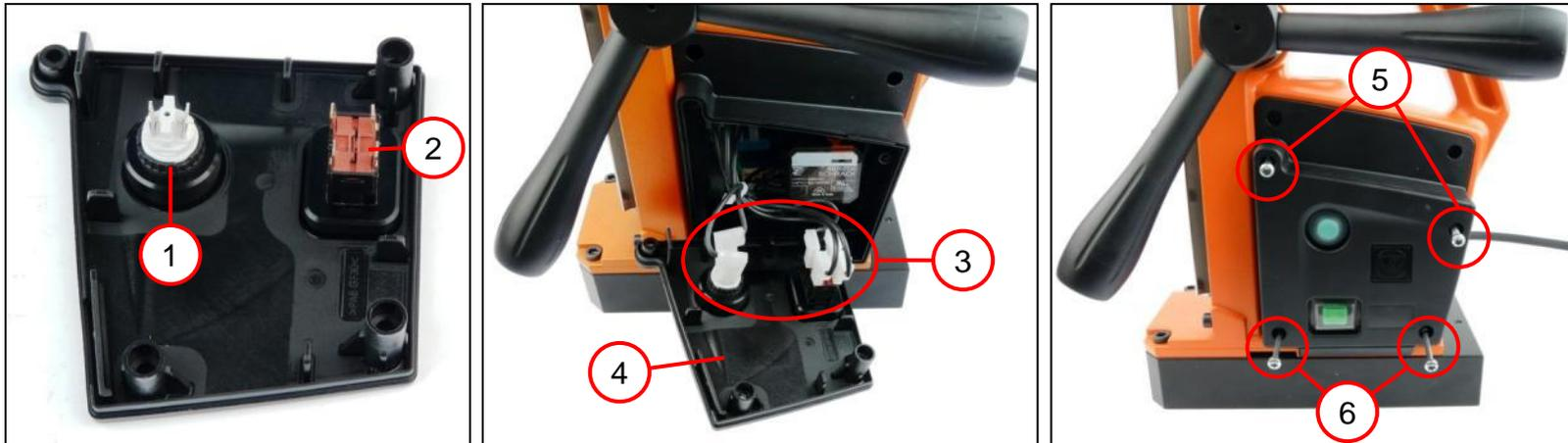
1. Den Taster (1) in den Deckel einsetzen und verschrauben.
