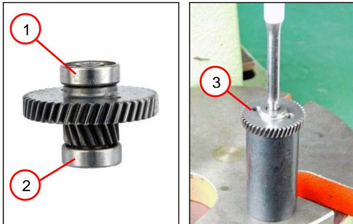
1. Das Rillenkugellager (1) von der Welle abziehen.
