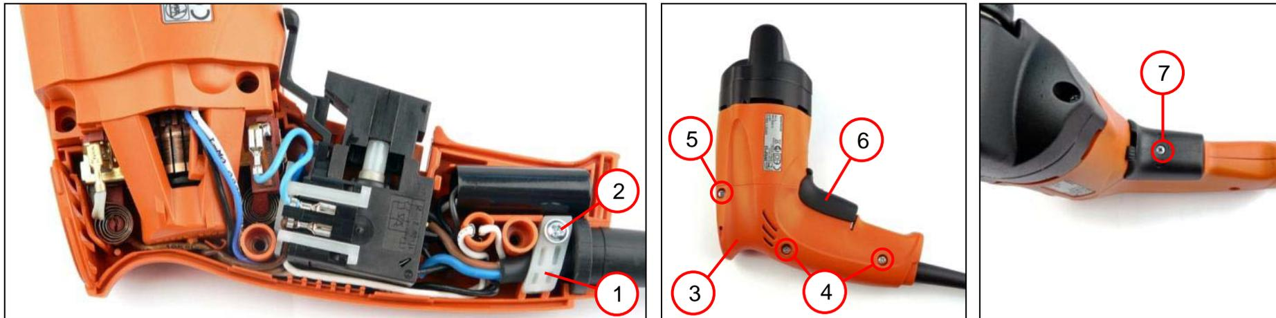
1. Alle elektronischen Bauteile, wie im ersten Bild, in der Gehäusehälfte platzieren.
