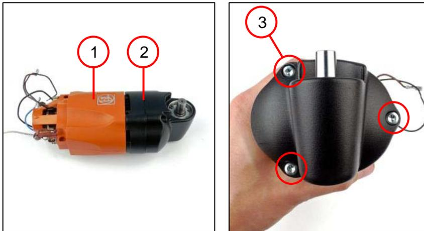
1. Das Motorgehäuse (1) auf das Getriebegehäuse (2) setzen.
