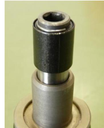
Kugel für die Fixierung des Schrauberbits in die Bohrung legen
