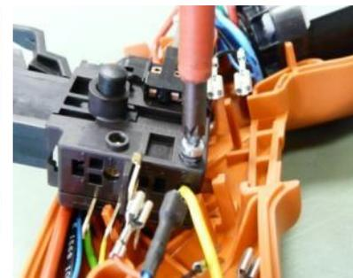
Schrauben am Motorgehäuse lösen und entfernen
