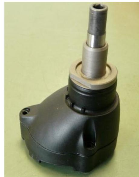
Scheibe, Axiallager und 2. Scheibe auf die Gleitlagerbuchse im Zwischenlager legen .
