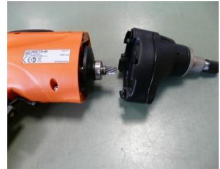
Akku, Gerüsthaken, Handschlaufe, Tiefenanschlagshülse und Schrauberbit entfernen
