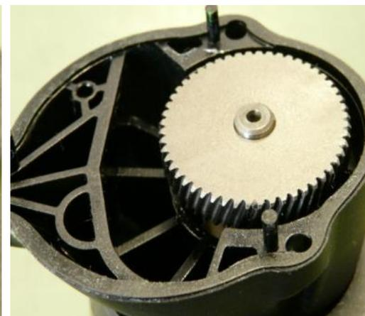
Welle mit Kupplungsringen ins Getriebegehäuse stecken
