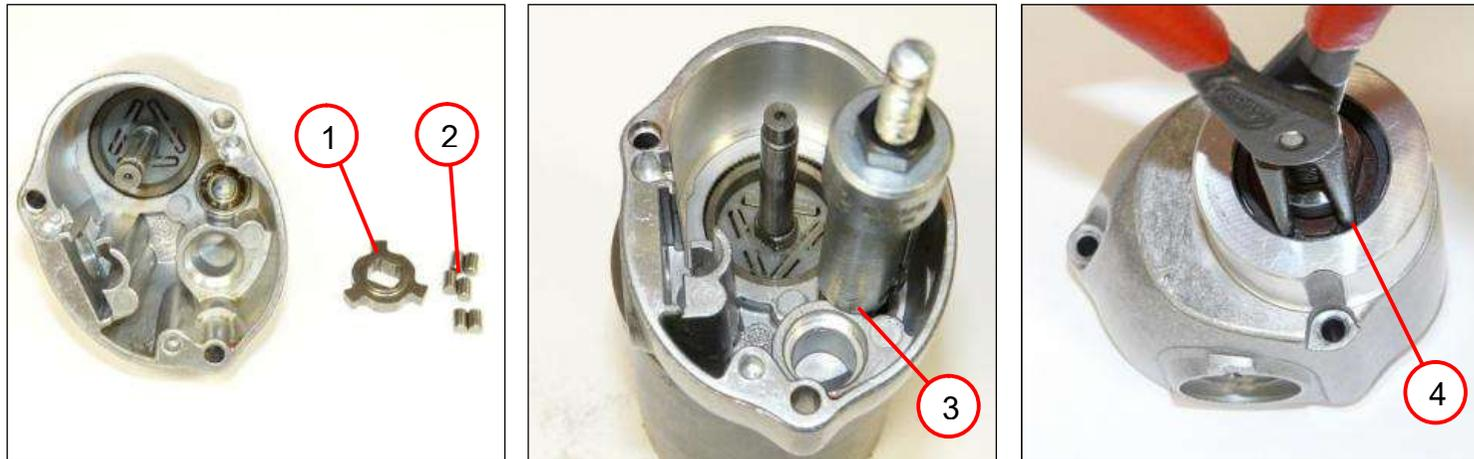
1. Den Kupplungsring (1) und die Rollen (2) entfernen.
