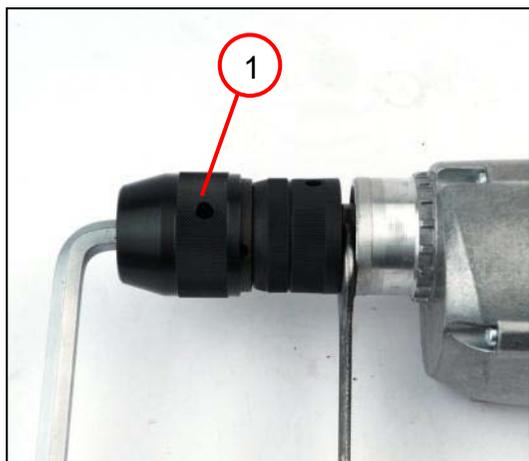
1. Montar el portabrocas de sujeción rápida (1).
