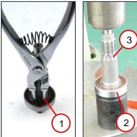
1. Den Sicherungsring (1) entfernen.
