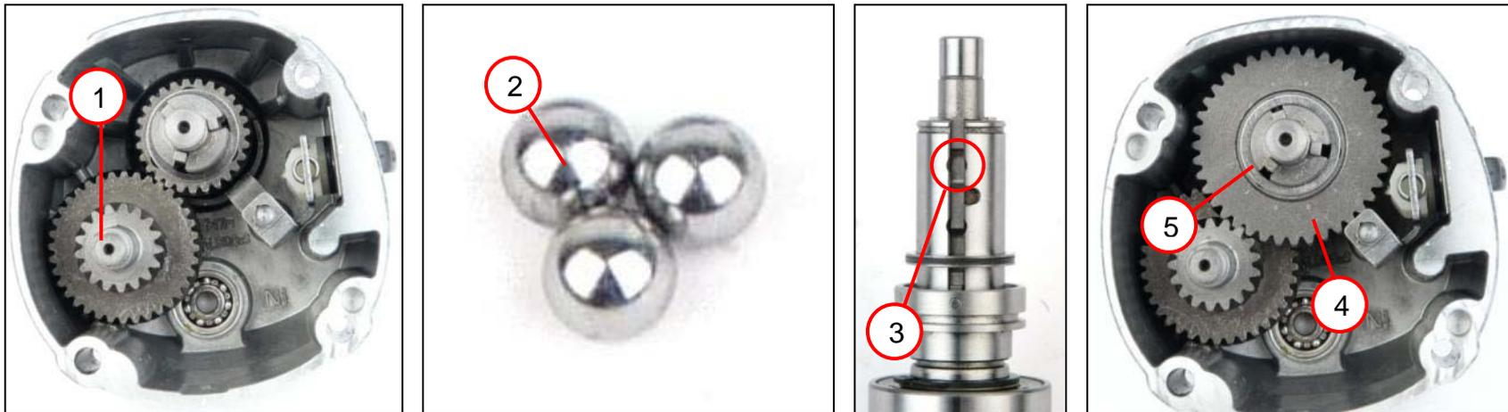
1. Die Welle (1) mit dem Zahnrad einsetzen.
