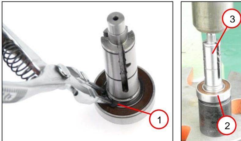
1. Den Sicherungsring (1) entfernen
