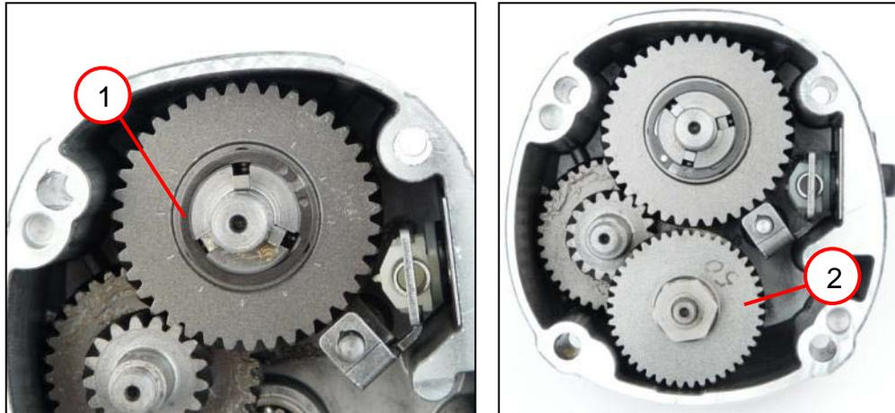
1. Den Sicherungsring (1) montieren.
