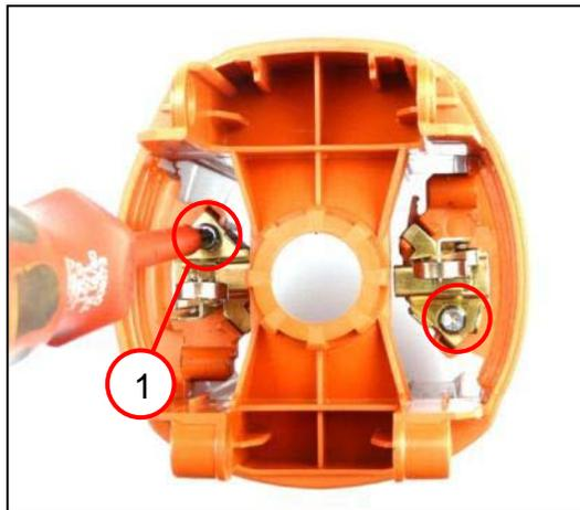
1. Die zwei Kohlebürstenhalter (1) einsetzen und mit der jeweiligen Schraube befestigen [ $1.2 \pm 0.15\text{Nm}$ ].
