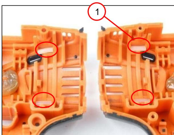
1. Insérer les quatre éléments de pression (1) dans le carter moteur.
