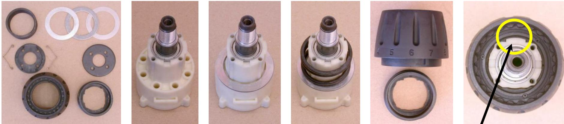
1. Stahlscheiben und Ringfeder auf das Gehäuse aufsetzen
