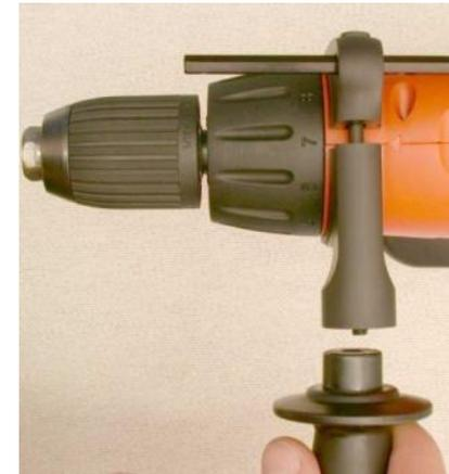
1. Handgriffhalterung über das Bohrfutter schieben, bis diese in die dafür vorgesehene Vertiefung am Gehäuse einrastet
