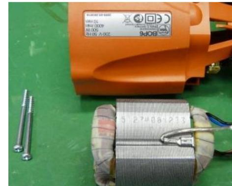
1. 松开定子接在开关上的插头触点
