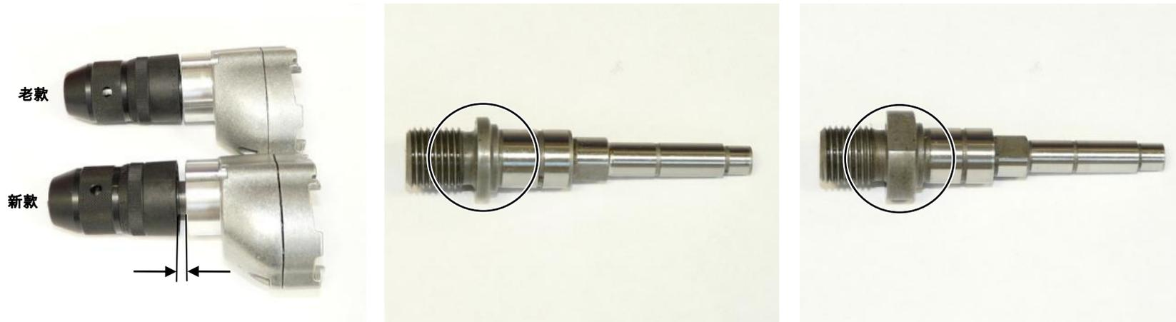
配备老款钻轴的机器（无扳手着力面）
