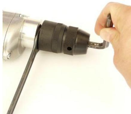
1. 将内六角扳手夹入钻夹头。
