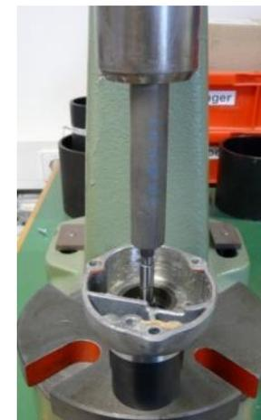
1. 轻轻敲击齿轮箱，取出齿轮 - 六枚销钉不得遗失，否则主轴锁定装置无法运行
