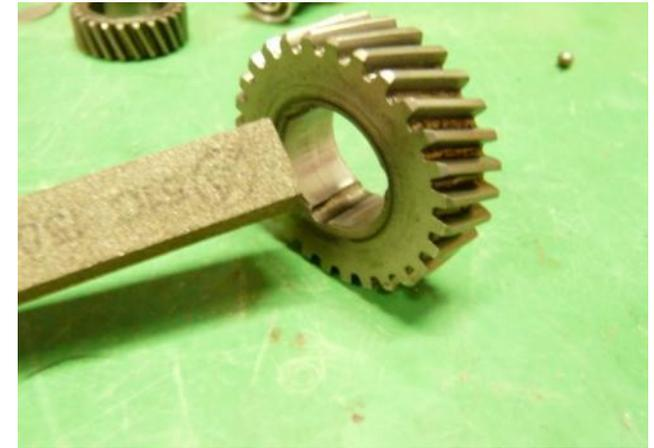
1. 取出齿轮 – 小心，齿轮下装有齿轮同步所必需的球，切勿遗失
