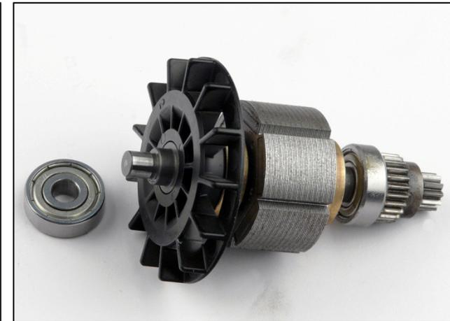
1. Das Rillenkugellager (1) abziehen.
