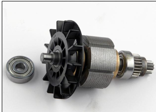
1. Снимите радиальный шарикоподшипник (1).
