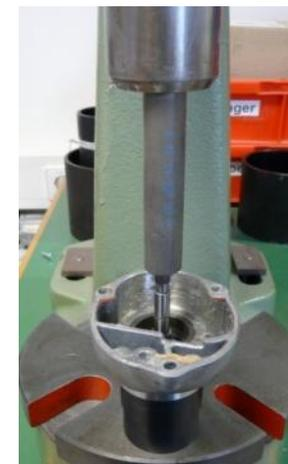
1. Легкими ударами по корпусу редуктора снимите зубчатое колесо (не потеряйте шесть болтов, иначе фиксация шпинделя перестанет работать).
