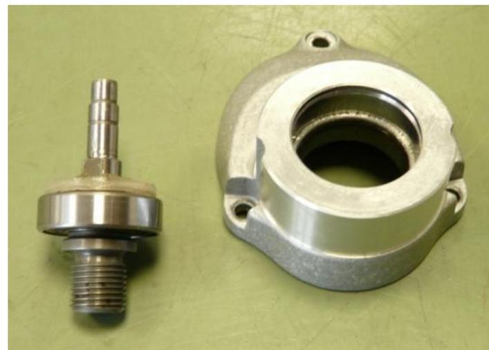
1. Снимите стопорное кольцо с шарикоподшипника.
