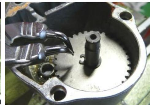
1. Снимите щит промежуточного подшипника.
