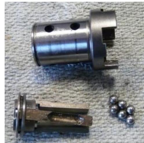
1. Снимите зубчатые колеса с поводка. **Внимание! Под зубчатыми колесами установлены шесть шариков!**
