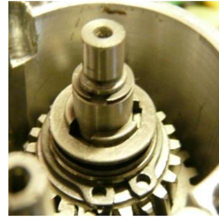
Для корректного переключения передач **необходимо** правильно установить стопорное кольцо. Оно должно быть введено в предусмотренный паз. Для монтажа стопорного кольца требуется специальный инструмент 64131017000, состоящий из гильзы и насадочного конуса (каталог специальных инструментов).
