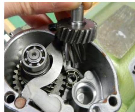
1. Снимите щит промежуточного подшипника, удалите пластичную смазку.
