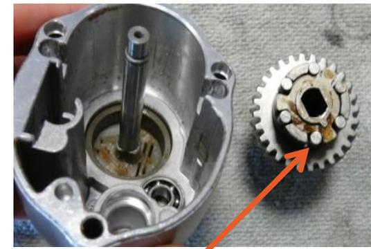
1. Снимите шарикоподшипник со сверлильного шпинделя.
