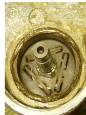
1. Снимите щит промежуточного подшипника.
