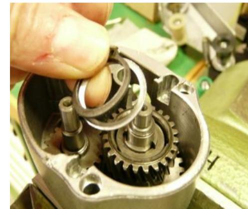
1. Отодвиньте пластинчатые пружины назад и извлеките их.
