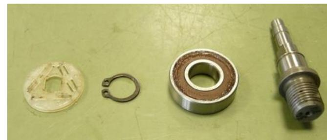
1. Снимите пластмассовую шайбу.
