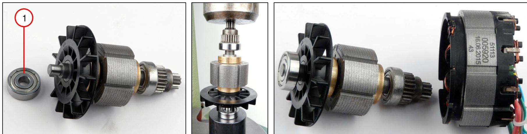
1. Presionar el cojinete rígido de bolas (1) en el rotor.
