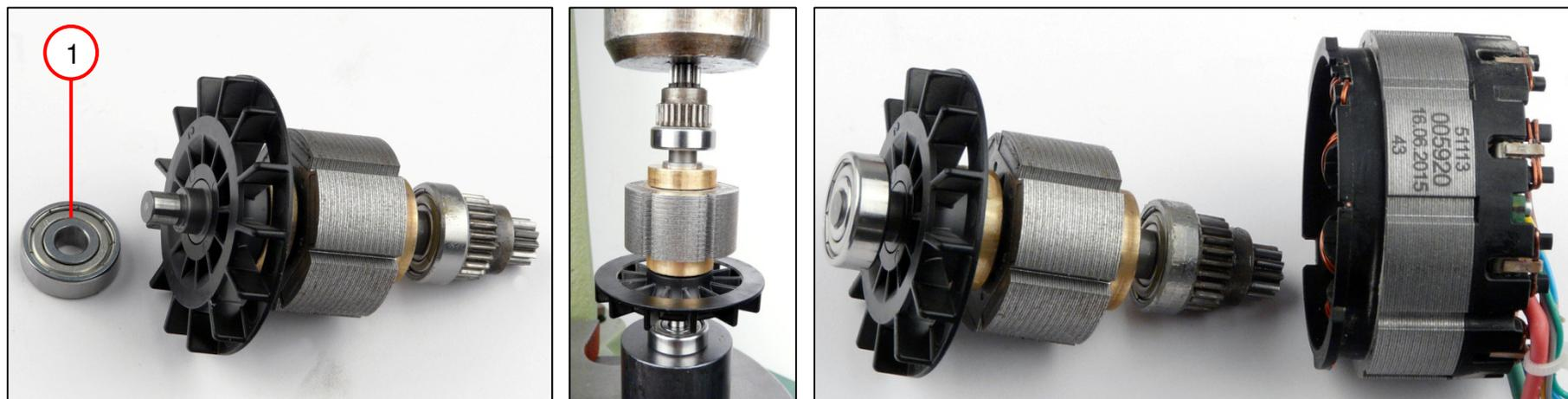
1. 将开槽球轴承 (1) 压到转子上。
