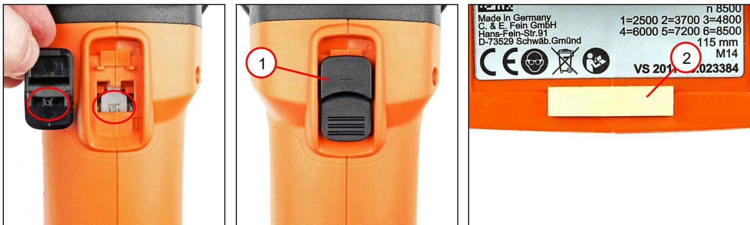
1. Mettre en place l'interrupteur (1).
