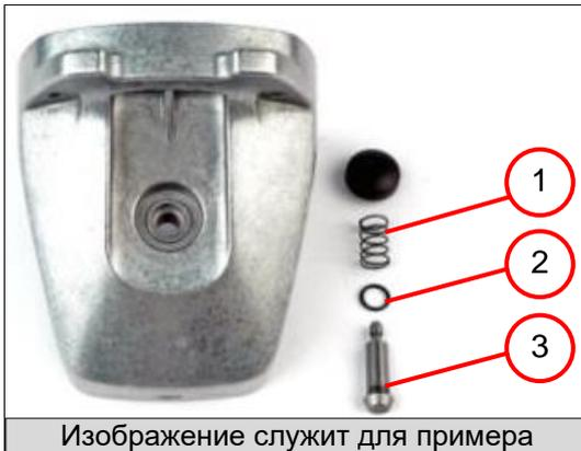
4. Снимите спиральную пружину (1).
