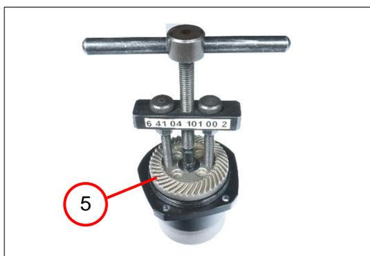
5. Установите съёмник на плоское колесо (5).
