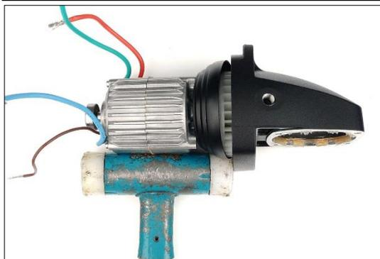
1. Снимите корпус редуктора.
