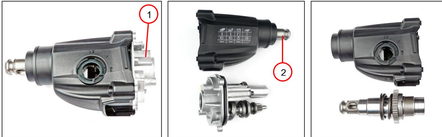
1. Das Getriebe (1) entfernen.
