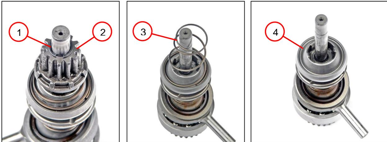
1. Den Sicherungsring (1) entfernen.
