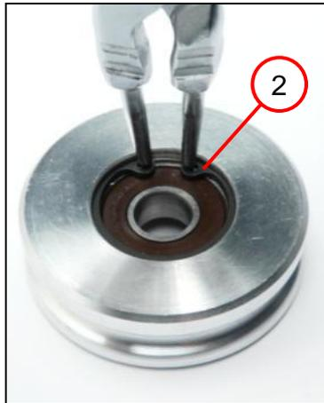
1. Das Rillenkugellager in die Rolle (1) pressen.
