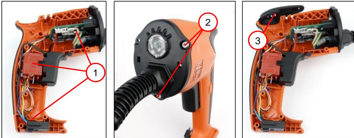
1. Die Elektronik-Bauteile (1) wie im Bild einlegen.
