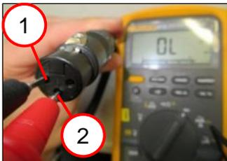
Conexión "+" en el DMM → Pin 3 (2)
