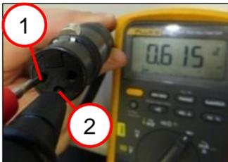
Conexión "+" en el DMM → Pin 2 (1)
