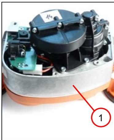
1. Colocar la carcasa (1) en la cubierta.
