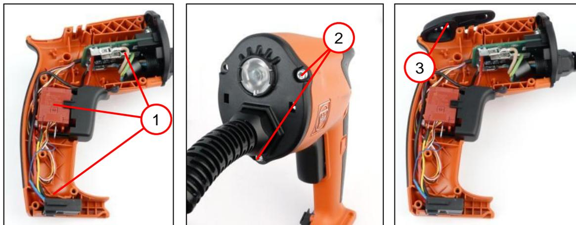
1. Fijar los componentes del sistema electrónico (1) como en la figura.
