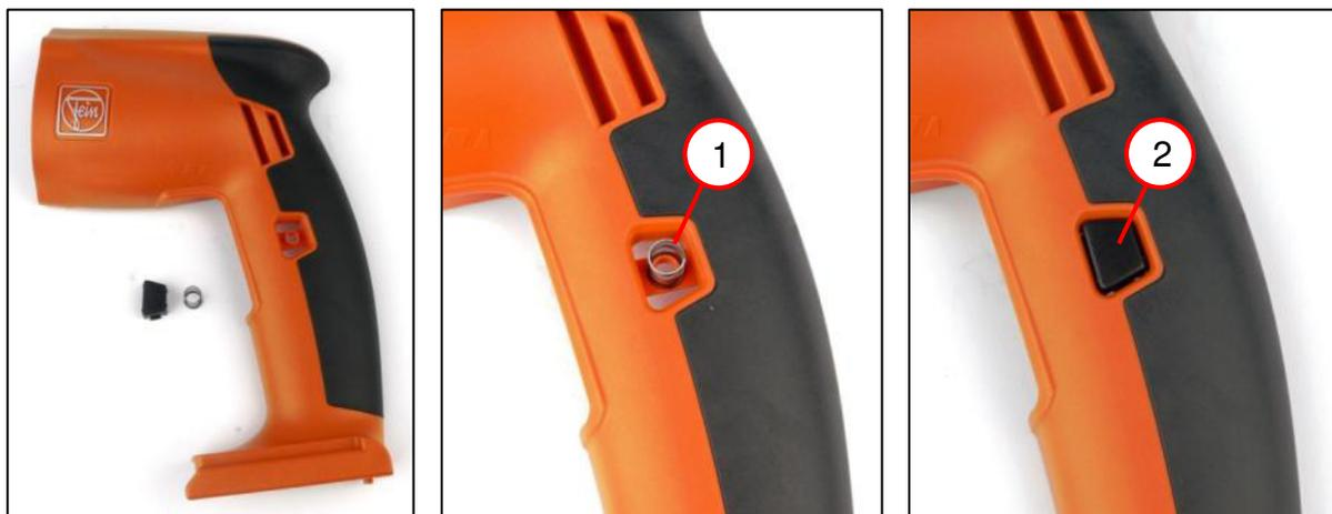
1. Вставьте спиральную пружину (1) в выемку.
